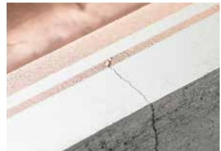
Bild 4: Dycobond®-Angussplatte (Ausschnitt) in Sandwichbauweise mit Makroriss im Stahl. Kühlkanal oben links, gerissener Formeinsatz unten rechts
